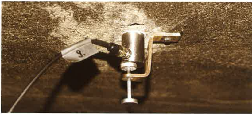
Bild 9. Schallemissionssensor (S1-S5) zur begleitenden Beobachtung des belastungsabhängigen Riverhaltens
